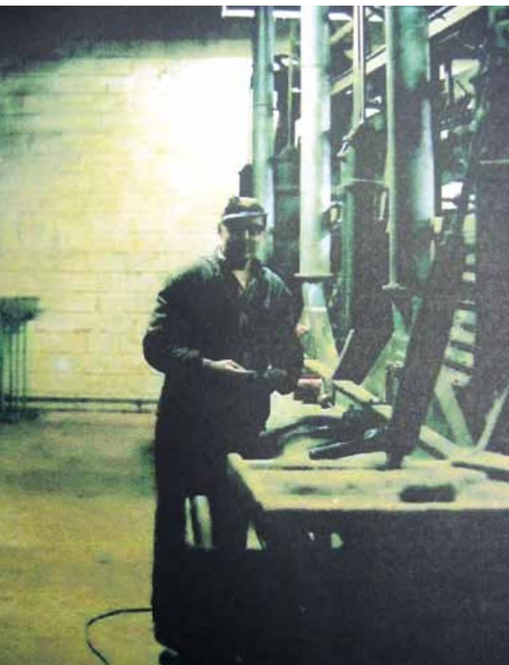
Ouvrier remplaçant des peignes endommagés sur une machine « EPEDA »
